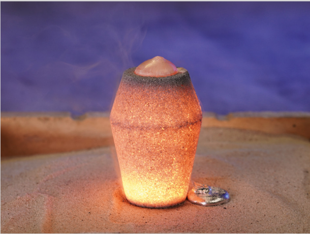
Şekil 4: FEEDEX NF1 besleyicinin stabil yanması
