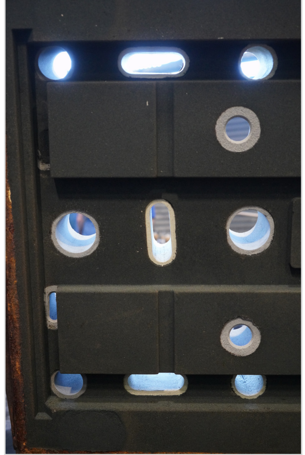
Şekil. 2: Kalıplama kutusuna yerleştirilmiş ekzotermik ve yalıtımlı besleyiciler
