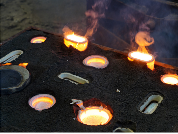
Şekil 3: FEEDEX NF1 besleyicinin ekzotermik reaksiyonu
